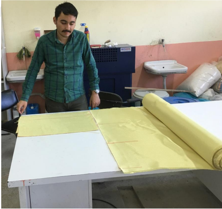
Şekil 4.12. Aramid Fiber Kumaşın Kesilip Hazırlanması
