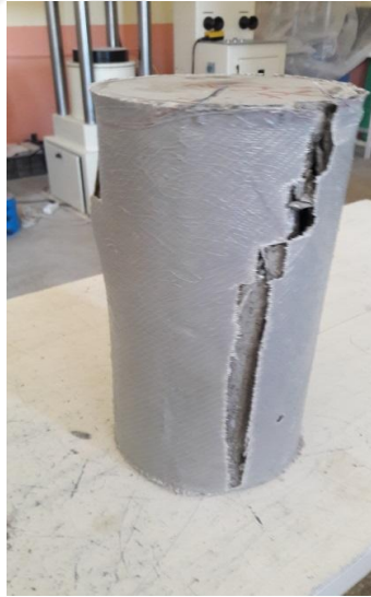
Şekil 5.13. Basınç Deneyinde Kırılmış GFRP Sargılı Beton Numune
