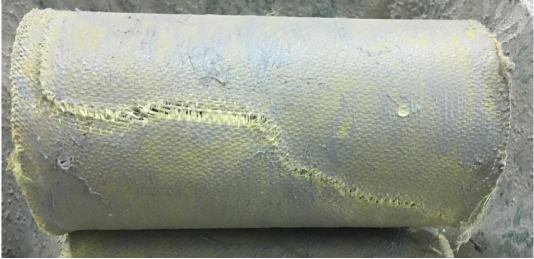
Şekil 5.32. Basınç Deneyinde Kırılmış AFRP Sargılı Beton Numune
