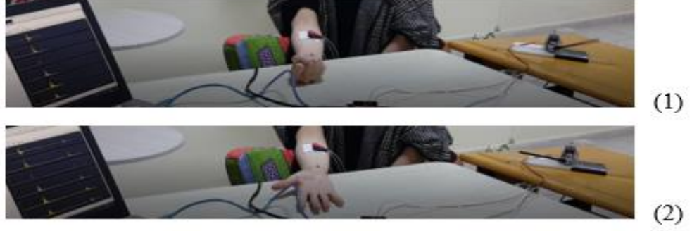
Şekil 5.9. Sistem çalışma mekanizması; el kapama/çalışma(1), el açma/durma(2)
