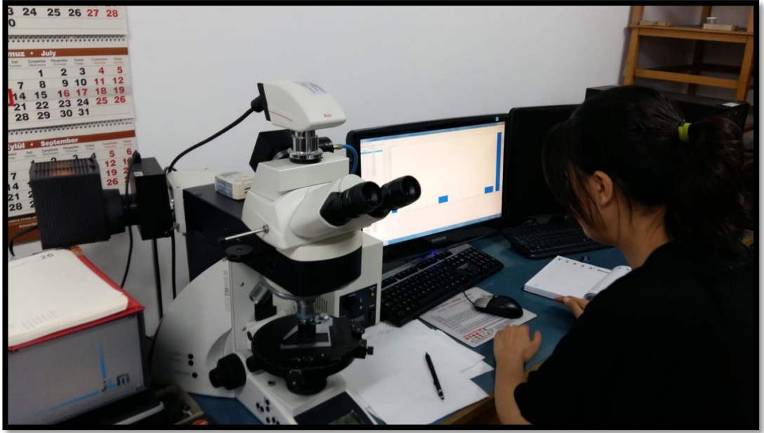
Şekil 3.1. Organik Petrografi İncelemeleri, Üstten aydınlatmalı mikroskop ve MSP-200 V344 bilgisayar programı ile Rrandom değerlerinin ölçülmesi
