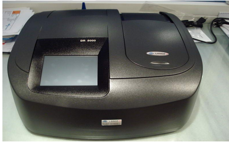
Şekil 3. 15. Hach Lange DR 5000 UV-Spektrometre absorpsiyon ölçüm cihazı
