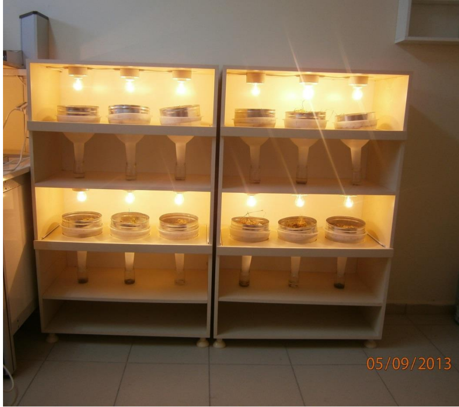
Şekil 2.2. Birleştirilmiş Berlese hunilerinden oluşan toprak akarlarını ayıklama düzeneği.
