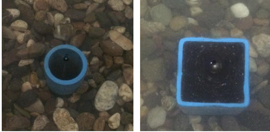
Şekil 3.7. Su Alma Borularında Hava Girişi
