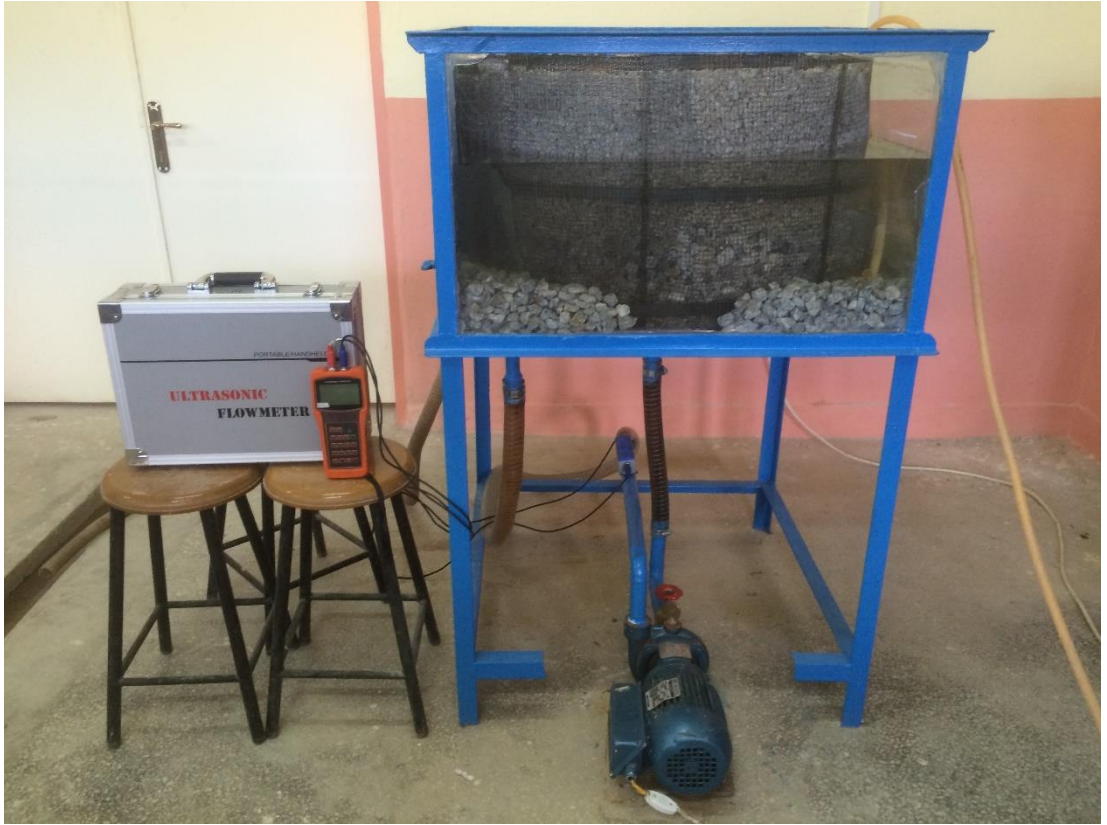
Şekil 3.2. Durgun Su Tankında Su Alma Borusuna Hava Giriş Deney Düzeneği
