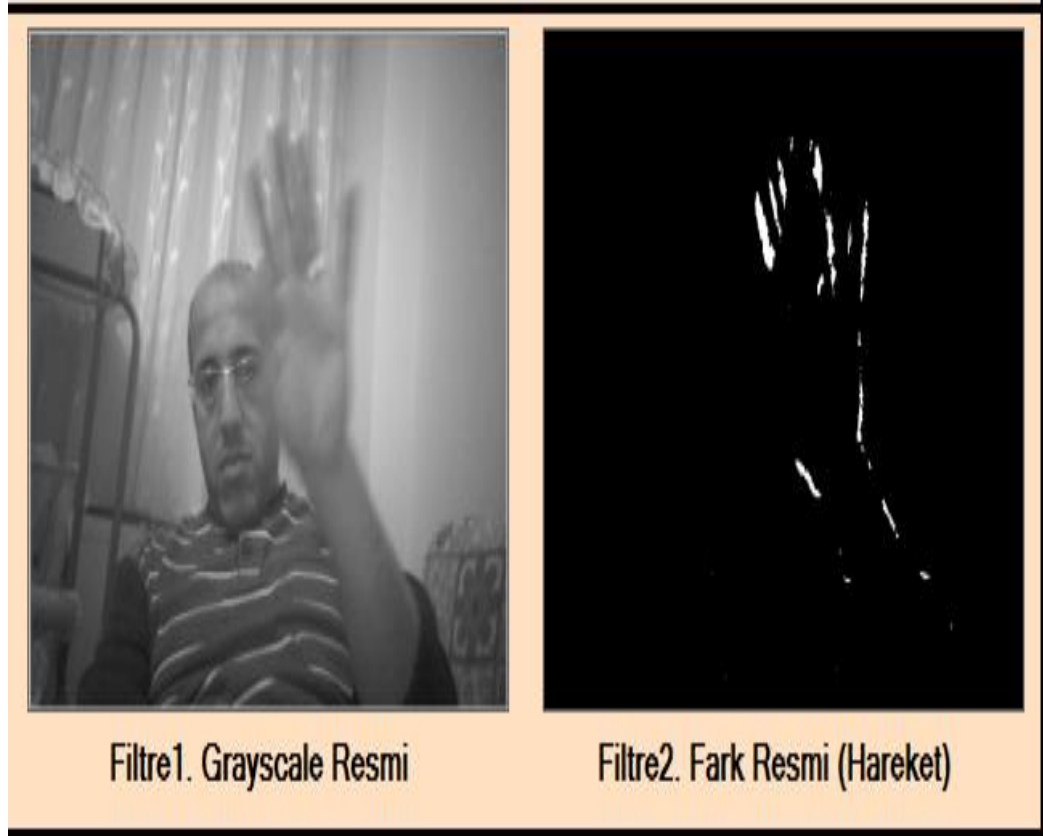
Şekil 4.24. Filtreler İle Elde Edilen Gri-Ton Ve Fark Resimleri
