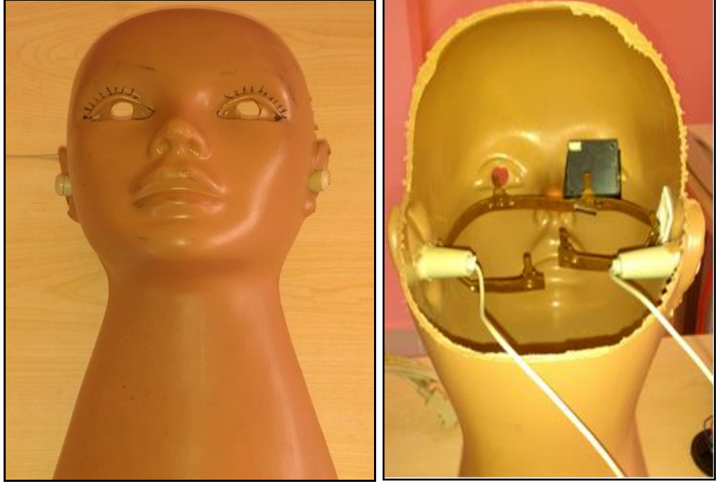
Şekil 4.16. Prototip Kamera Ve Mikrofon Bağlantısı
