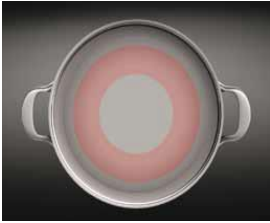
Şekil 4.1 Tencere Tabanında Isıya Maruz Kalan Yüzeyler[42]
