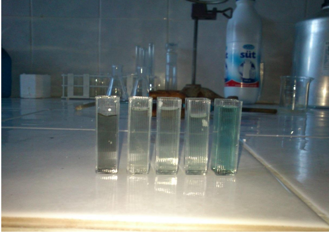
Şekil 6.17. Soldan sağa 75, 100, 150, 200, 300 ppm lik derişimdeki Metilen Mavisi ne HCK ile muamaele edilmesi sonucu oluşan örnekler.
