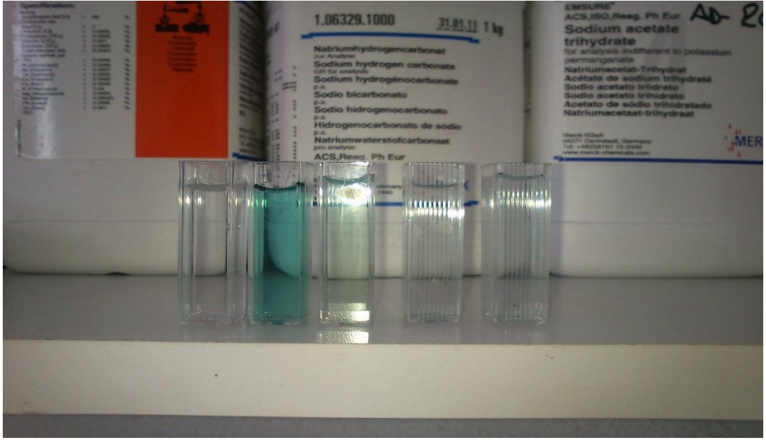
Şekil 6.24. 25 °C de yapılan adsorpsiyon sonucu elde edilen örnekler Soldan saęa saf su CK, HCK, SCK, FCK 25 °C c= 50 ppm
