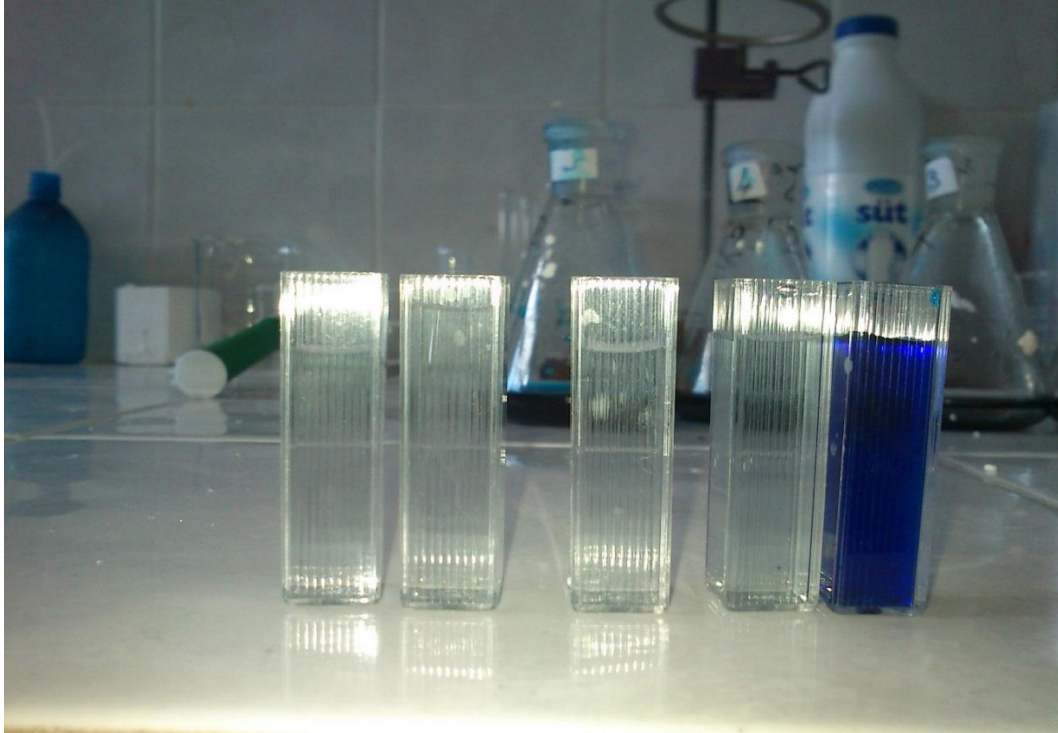
Şekil 6.18. Soldan sağa 75, 100, 150, 200, 300 ppm lik derişimdeki Metilen Mavisi ne SCK ile muamaele edilmesi sonucu oluşan örnekler.
