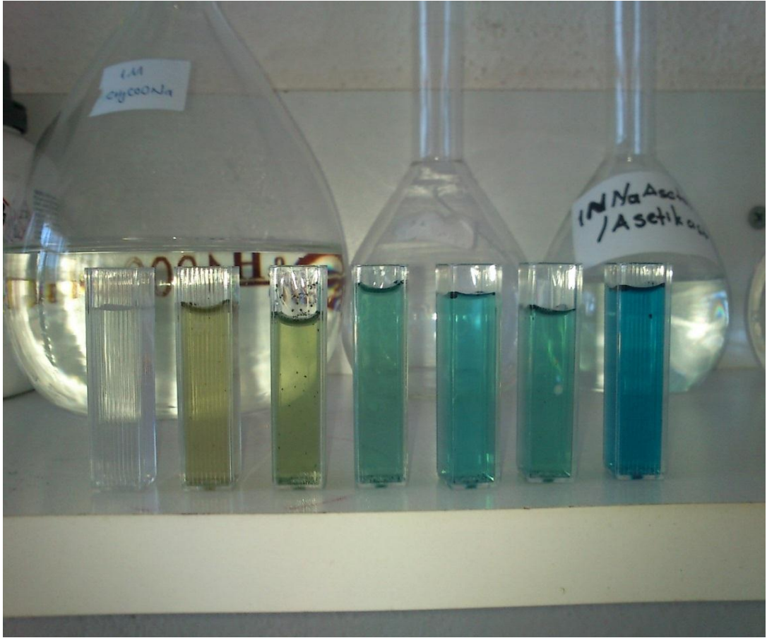
Őekil 6.16. Soldan saęa saf su, 25, 50, 75, 100, 150, 200, 300 ppm lik deriřimdeki Metilen Mavisi ne CK ile muamaele edilmesi sonucu oluřan rnekler.
