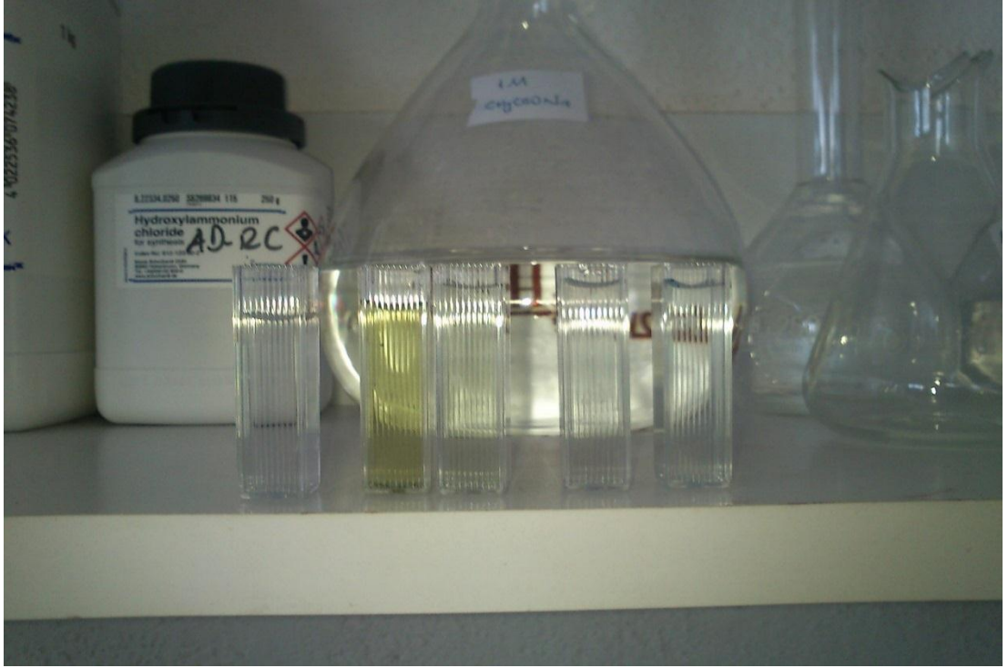
Şekil 6.25 35 0 C de yapılan adsorpsiyon sonucu elde edilen örnekler Soldan sağa sırası ile saf su CK, HCK, SCK, FCK 35 0 C c= 50 ppm
