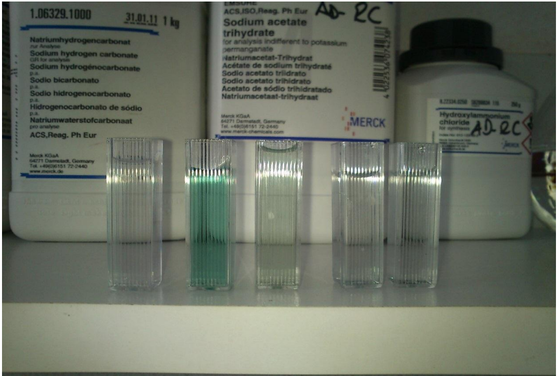
Şekil6.26 45 0 C de yapılan adsorpsiyon sonucu elde edilen örnekler Soldan sağa sırası ile saf su CK, HCK, SCK, FCK 45 0 C c= 50 ppm
