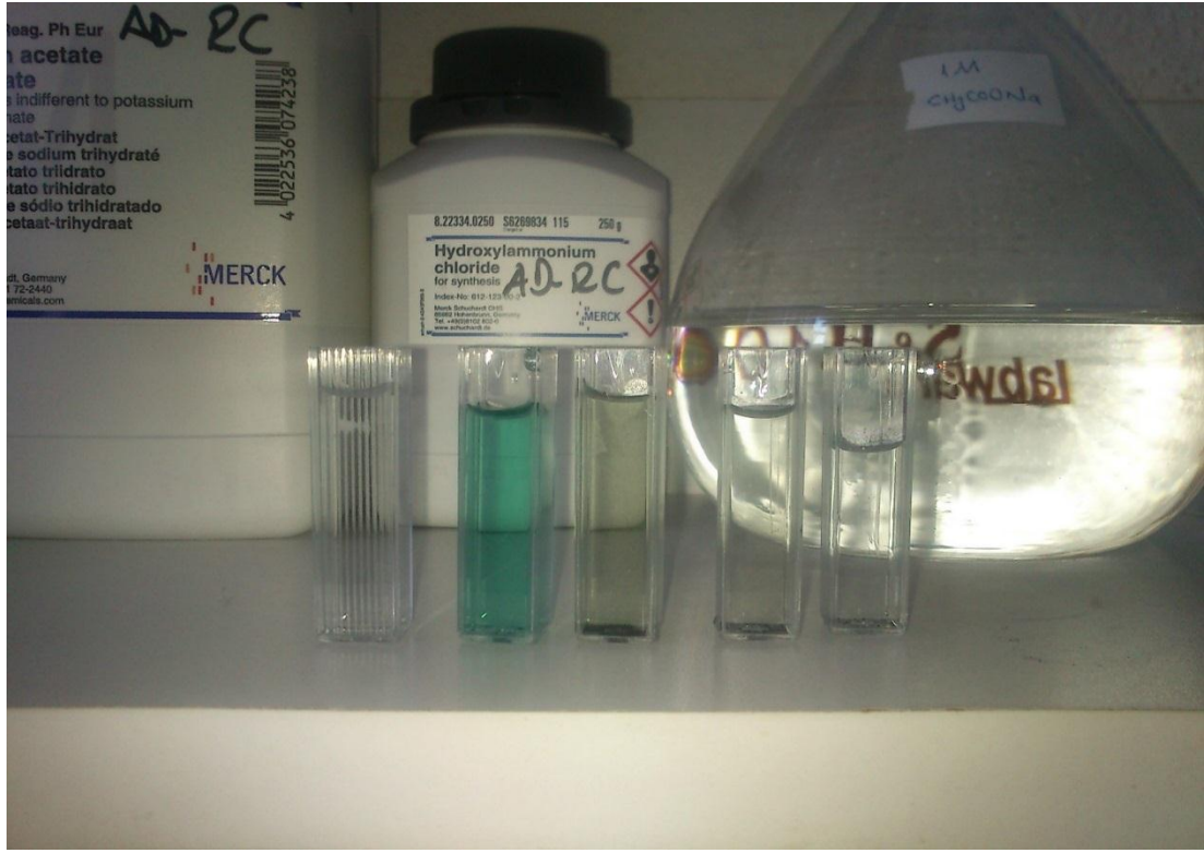
Şekil6.27 60 °C de yapılan adsorpsiyon sonucu elde edilen örnekler Soldan sağa saf su CK, HCK, SCK, FCK 60 °C c= 50 ppm
