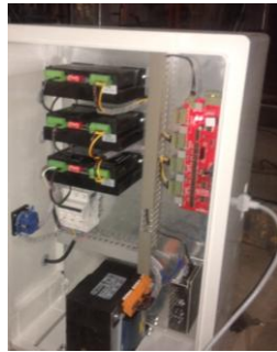
Şekil 3.13 Prototip CNC Freze Tezgâhında Kullanılan Kontrol Ünitesi
