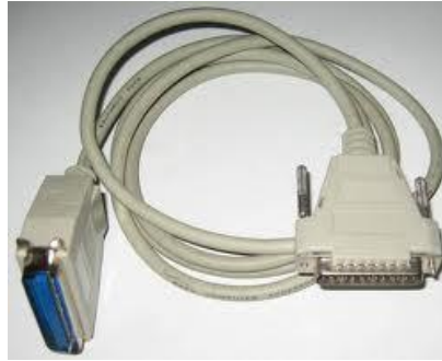
Şekil 3.14 Prototip CNC Freze Tezgâhında Kullanılan LPT Kablosu
