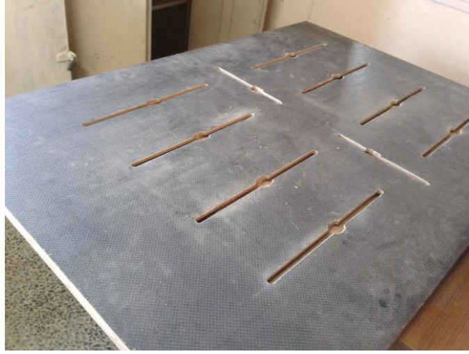
Şekil 3.4 Prototip CNC Freze Tezgahında Kullanılan Tabla
