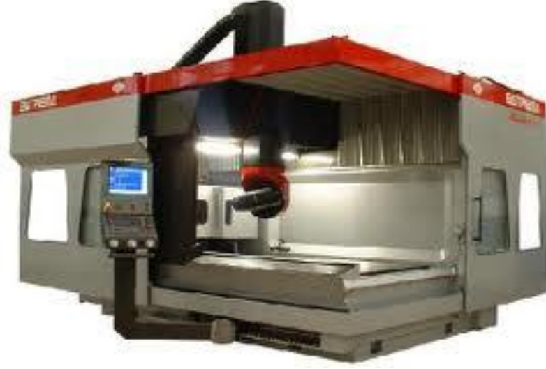
Şekil 1.2 Bir CNC İşleme Merkezi
