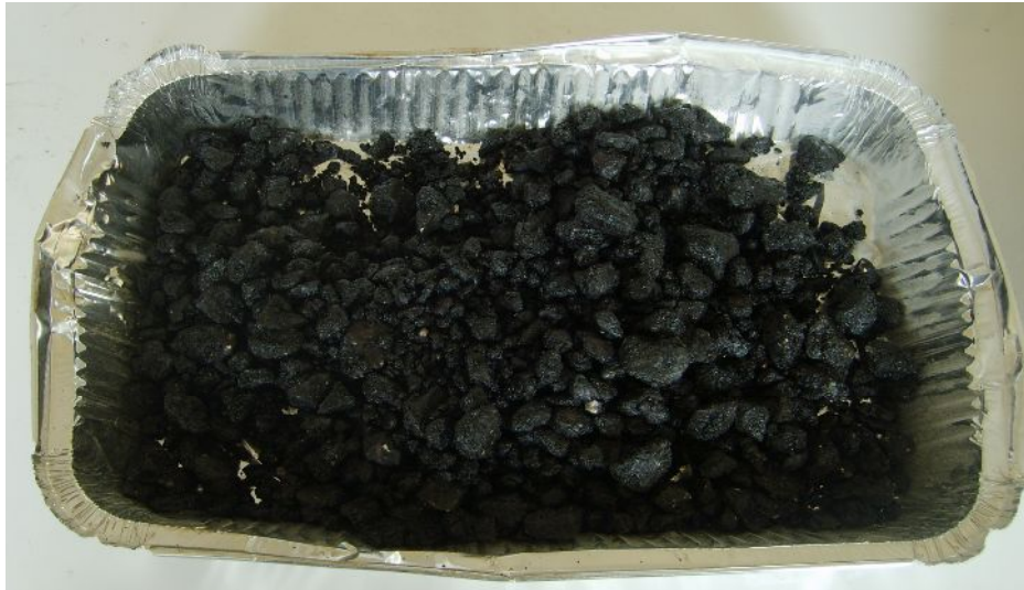
Şekil 6.3 Maksimum Teorik Özgül Ağırlık Hesabında Kullanılan Bitümlü Karışım.
