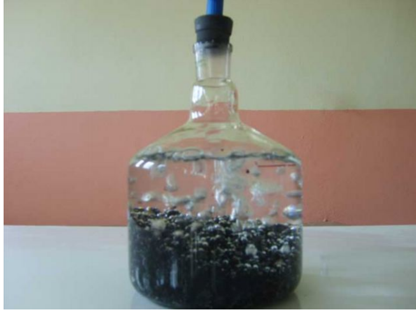
Şekil 6.4 Sıkıştırılmamış Numuneler Üzerine Vakum Uygulanması.
