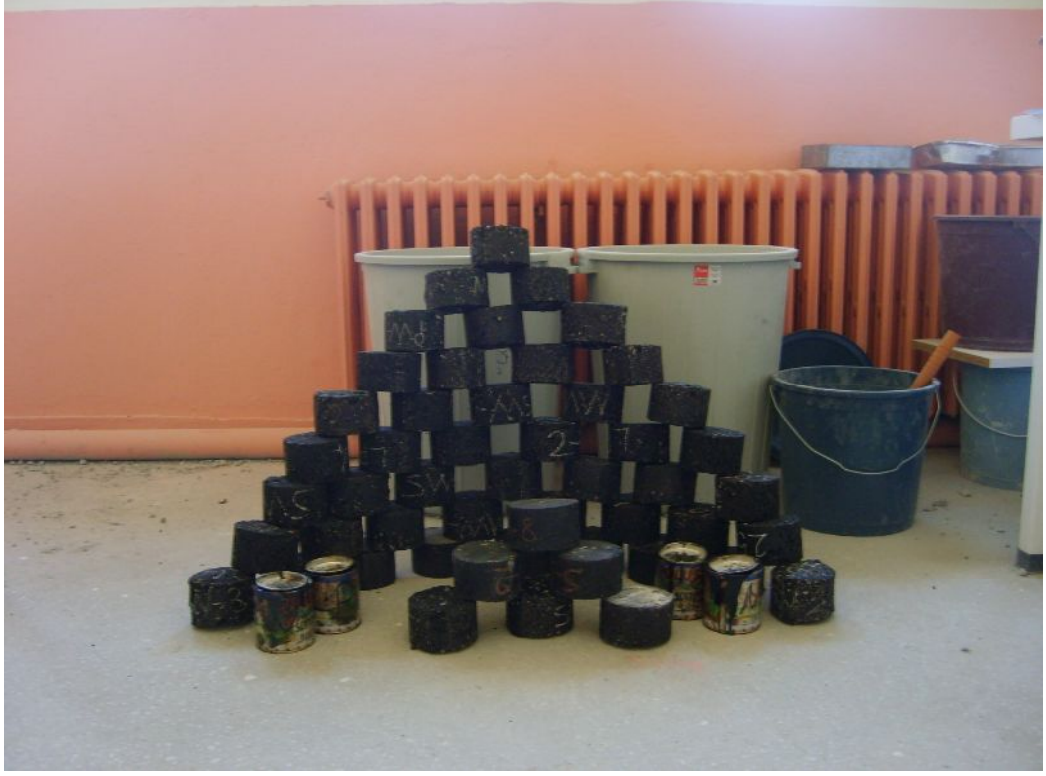
Şekil 6.7 Deneysel Çalışmada Hazırlanan Sıkıştırılmış Numuneler.
