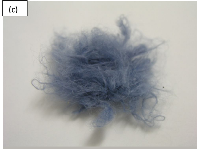
Şekil 6.12. Dispers, Asidik ve Bazik boya ile boyanmış Saf PET'in makro fotoğrafları (a) Dispers boya, (b) Asidik boya, (c) Bazik boya
