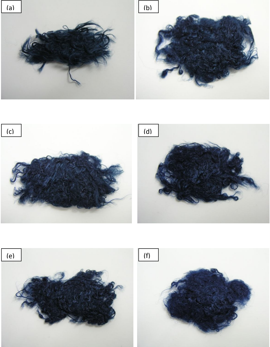
Şekil 6.13. Dispers boya ile boyanmış değişik aşılama verimlerine sahip PET liflerin makro fotoğrafları (a) %20,9, (b) %72,0, (c) %74,5, (d) %85,4, (e) %147,9, (f)%149,2 MAA/MAAm Aşılı
