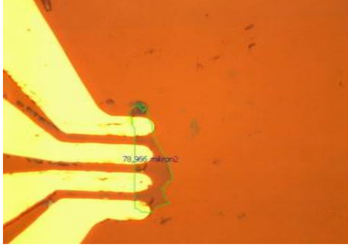
Şekil 4.5 Elektriksel kontakları alınmış grafen numunenin görüntüsü.
