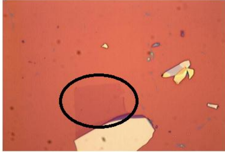
Şekil 4.2 Optik mikroskopun 100X merceği altında HOPG den elde edilen grafenin görüntüsü.
