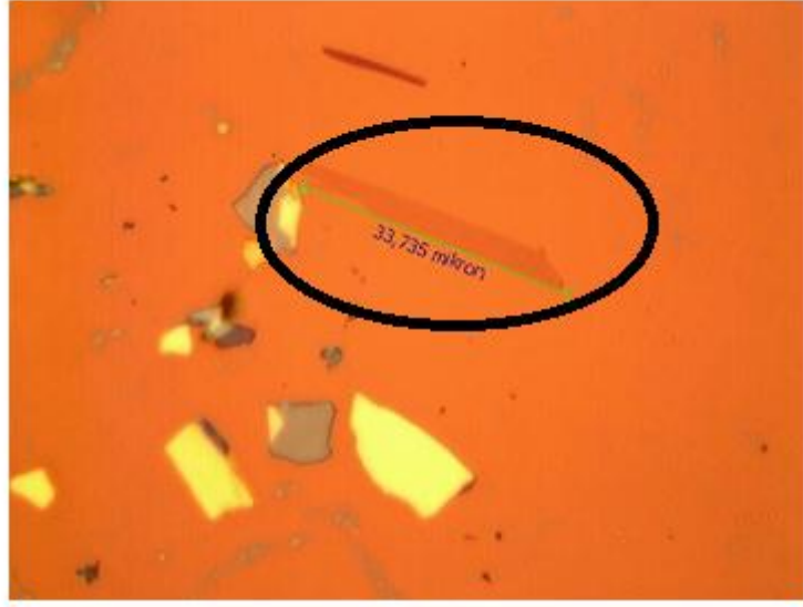
Şekil 4.3 Optik mikroskobun 100X merceği altında Kish grafitten elde edilen grafenin görüntüsü.
