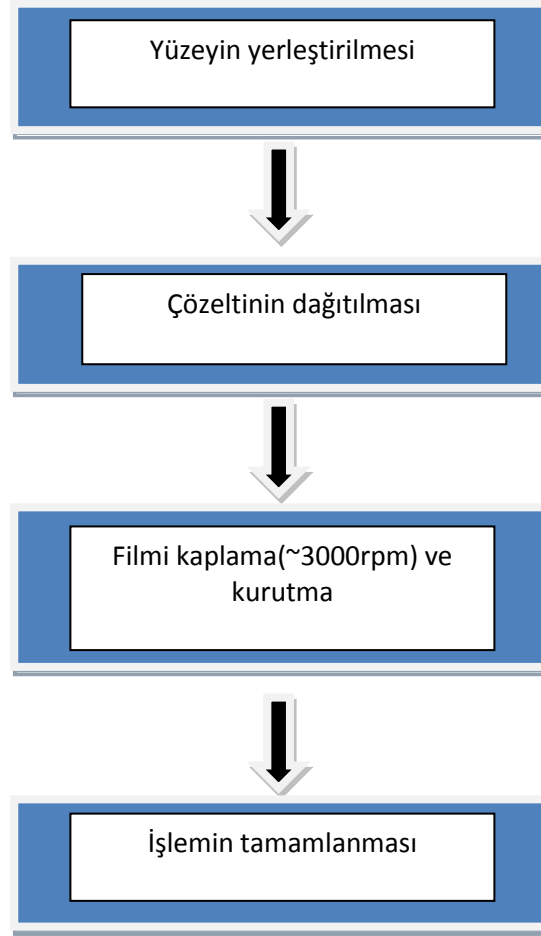
Şekil.2.6. Spin kaplama aşamalarının şematik gösterimi
