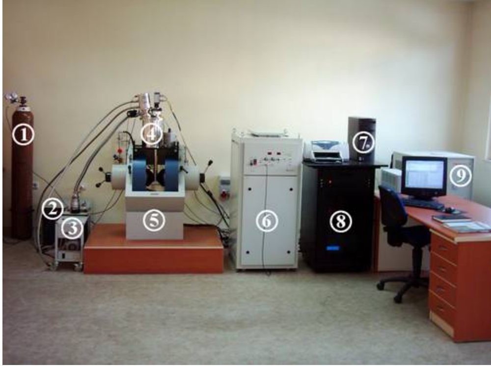
Şekil 4.14. Lakeshore 7700A Tipi Yüksek Empedans Hall Etkisi Sistemi (1) He Tüpü, (2) Kapalı Devre He Soğutma Ünitesi, (3) Vakum Pompası, (4) Kryostat, (5) Magnet Sistemi, (6) Magnet Güç Kaynağı, (7) Bilgisayar, (8) Sıcaklık Kontrol Ünitesi, Ölçüm Cihazları, Anahtarlama Sistemi, Manyetik Alan Ölçüm Sistemi vb... İçeren Enstrüman Dolabı, (9) Su Soğutma Sistemi
