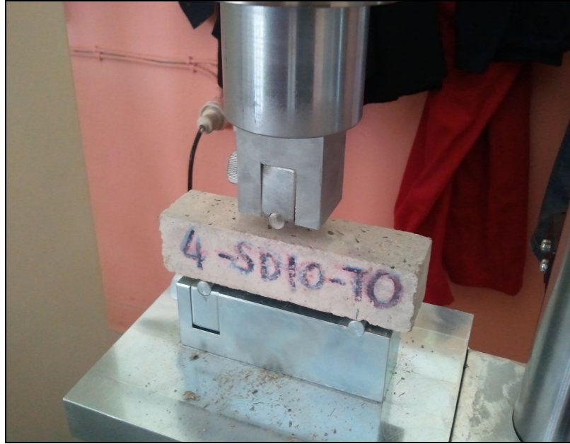
Şekil 3.16. Eğilme Dayanımı Tayini Deney Cihazı
