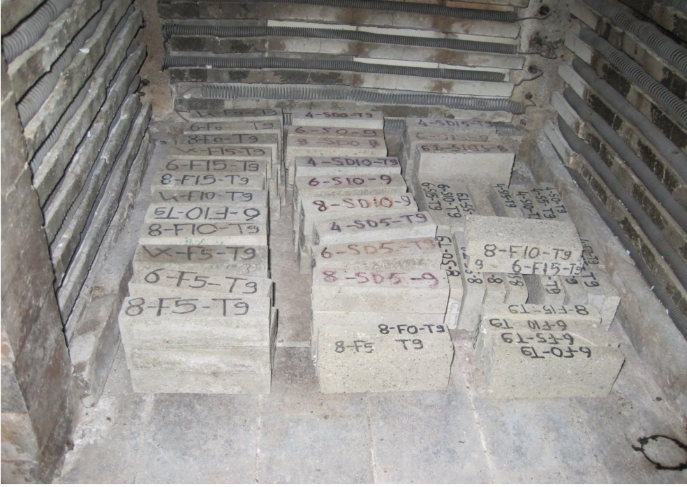
Şekil 3.11. Numunelerin Sıcaklık Uygulanmadan Önceki Durumu
