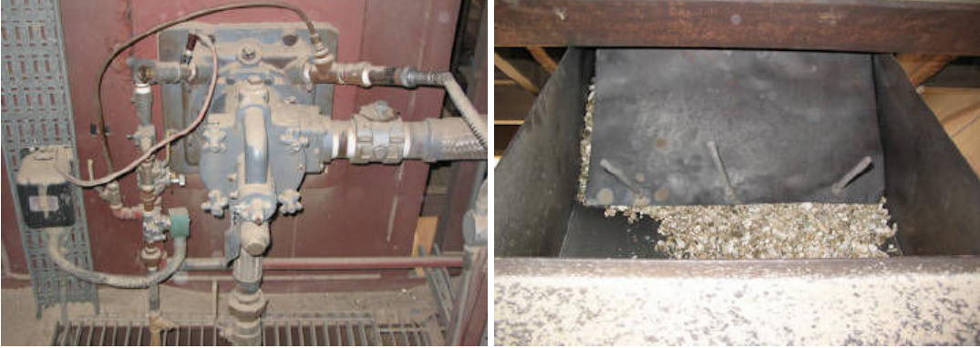
Şekil 2.13. Düşey fırında vermikülitin geniştirilmesi [62]
