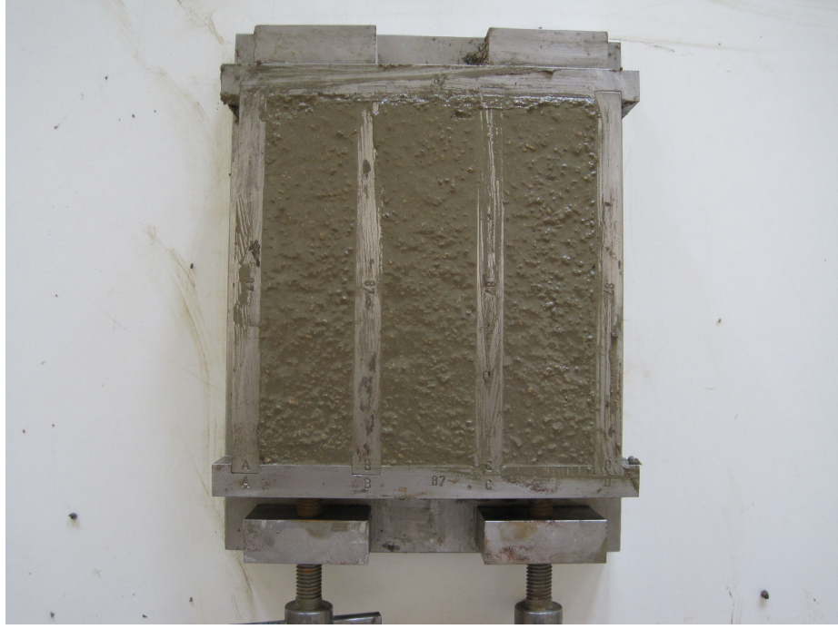
Şekil 3.8. Harcın Kalıba Yerleştirilmiş Hali
