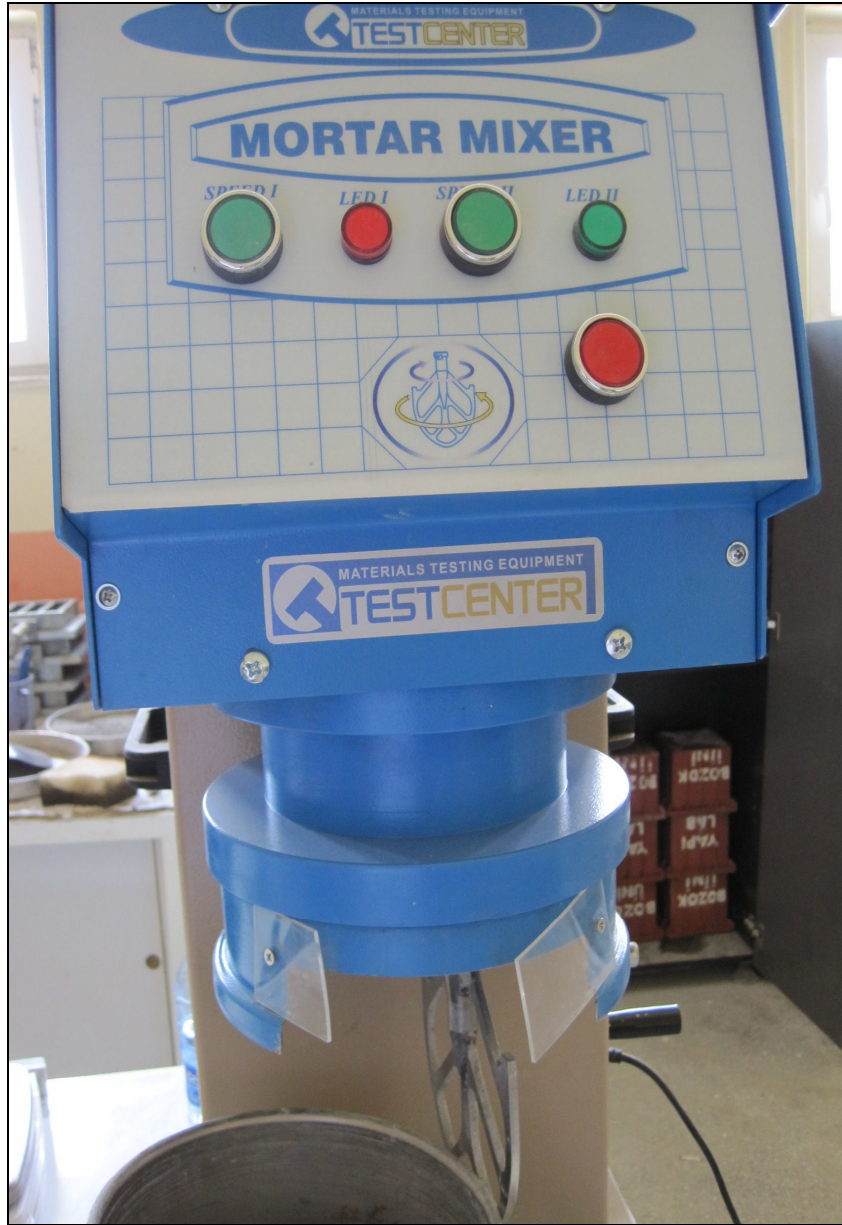
Şekil 3.5. Çalışmada Kullanılan Çimento Mikseri
