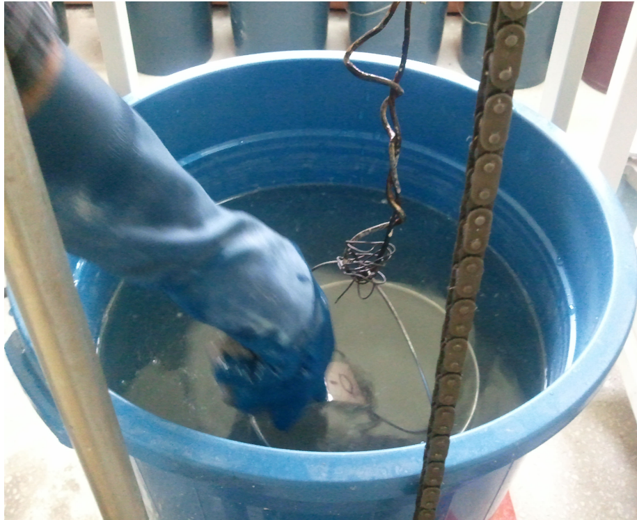
Şekil 3.14. Numunelere Arşimet Deneyi Yapılması
