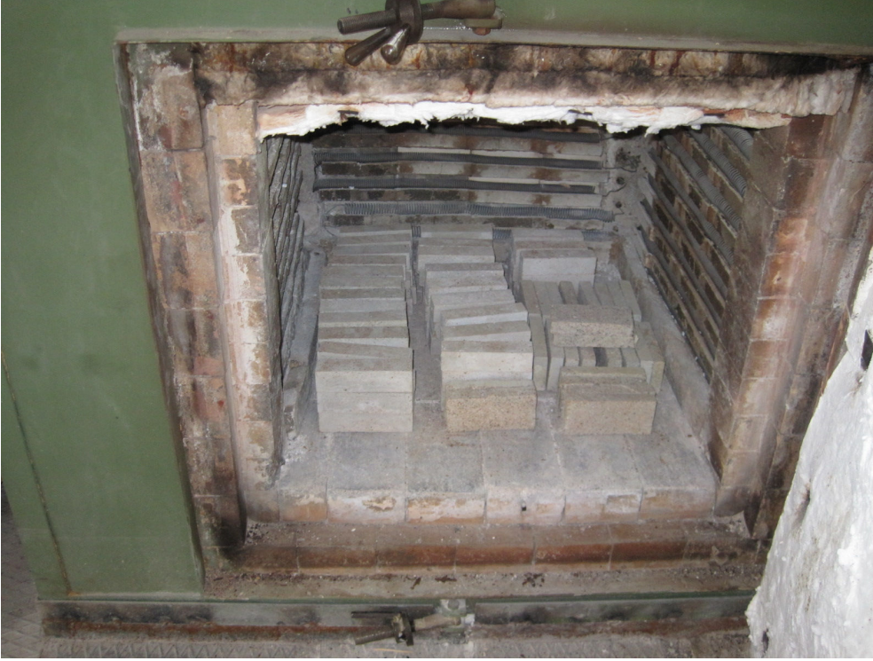
Şekil 3.12. Numunelerin Sıcaklık Uygulandıktan Sonraki Durumu
