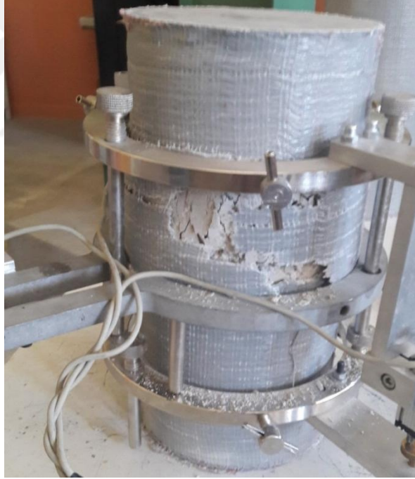
Şekil 5.43. GFRP-C20 Çift Sarım Beton Numunesi Deney Sonrası
