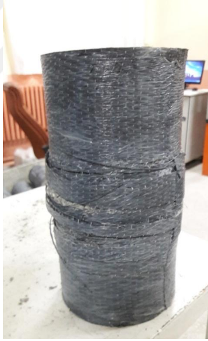
Şekil 5.32. CFRP-C50 Çift Sarım Beton Numunesi Deney Sonrası
