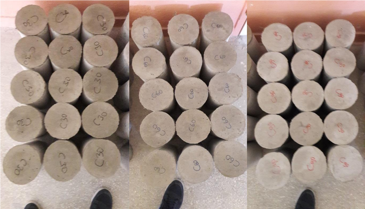
Şekil 5.13. C20, C50, C75 Beton Silindir Numuneleri Ayrı Ayrı
