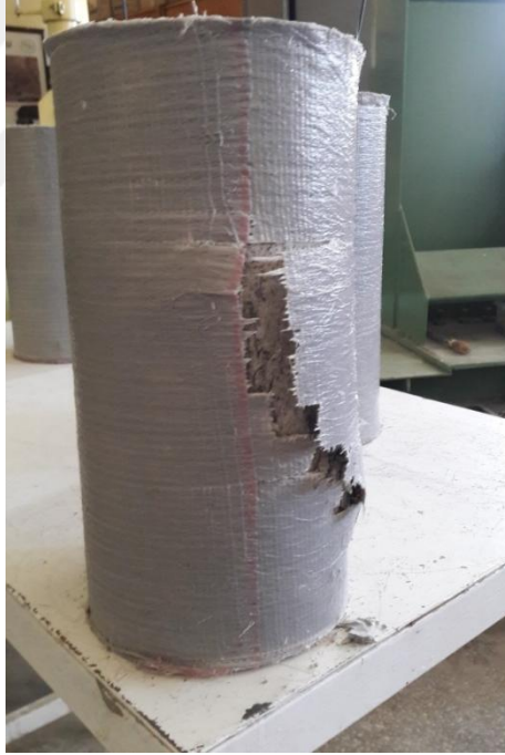
Şekil 5.45. GFRP-C50 Tek Sarım Beton Numunesi Deney Sonrası
