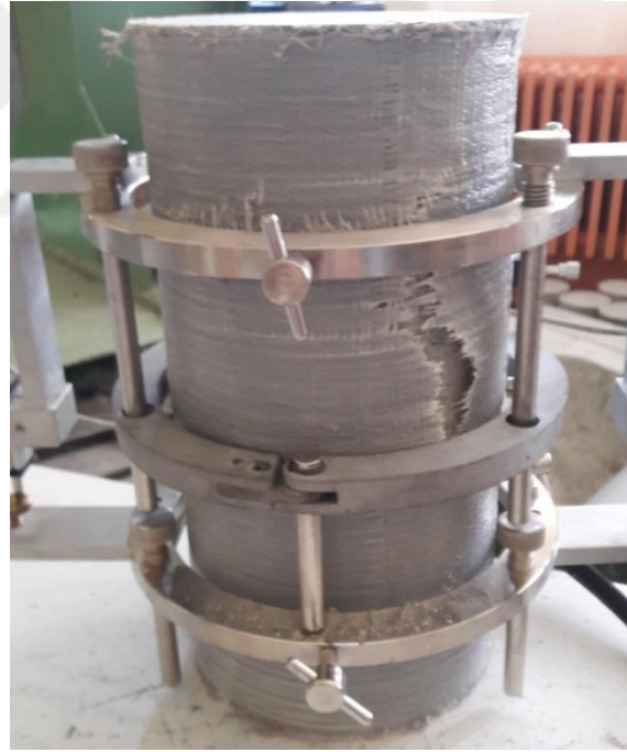
Şekil 5.47. GFRP-C50 Çift Sarım Beton Numunesi Deney Sonrası
