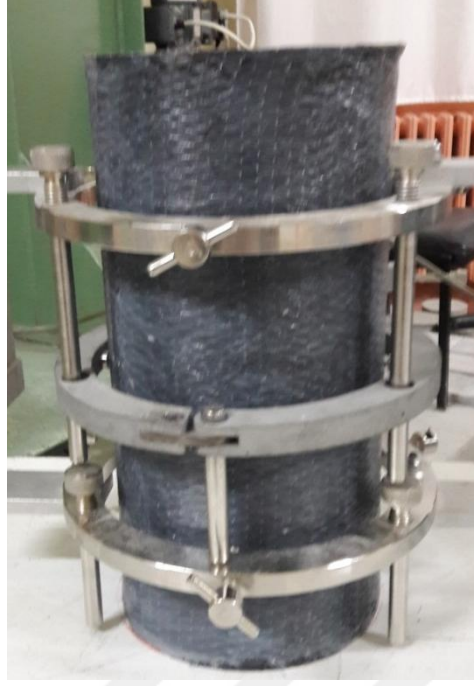
Şekil 5.29. CFRP-C50 Tek Sarım Beton Numunesi Deney Öncesi
