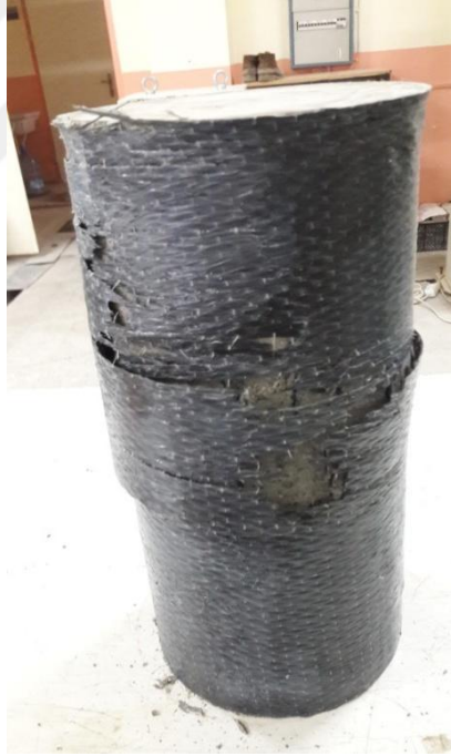
Şekil 5.36. CFRP-C75 Çift Sarım Beton Numunesi Deney Sonrası
