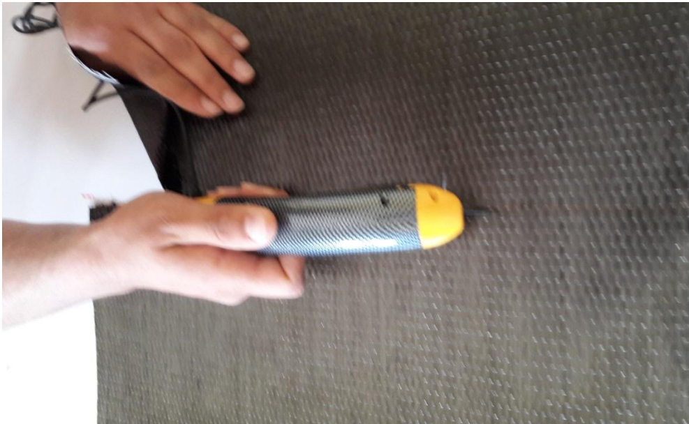
Şekil 5.11. Karbon Elyaf Kumaşın Kesilmesi
