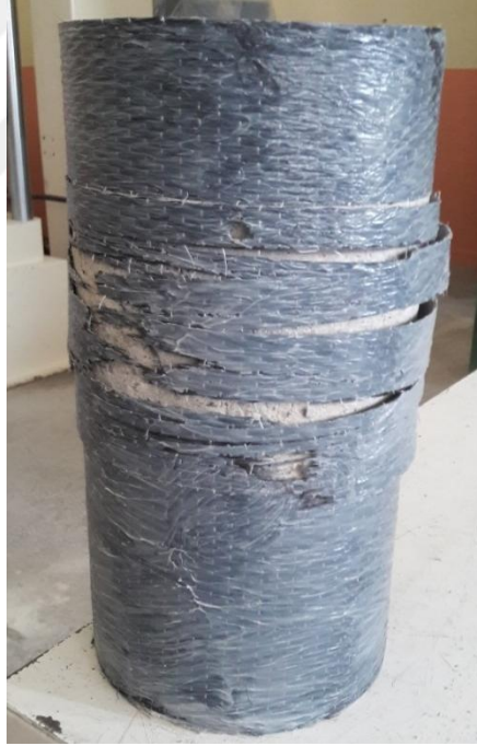
Şekil 5.28. CFRP-C20 Çift Sarım Beton Numunesi Deney Sonrası
