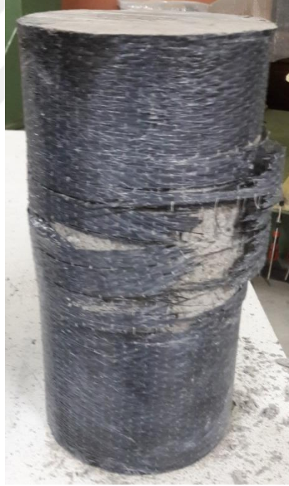
Şekil 5.30. CFRP-C50 Tek Sarım Beton Numunesi Deney Sonrası
