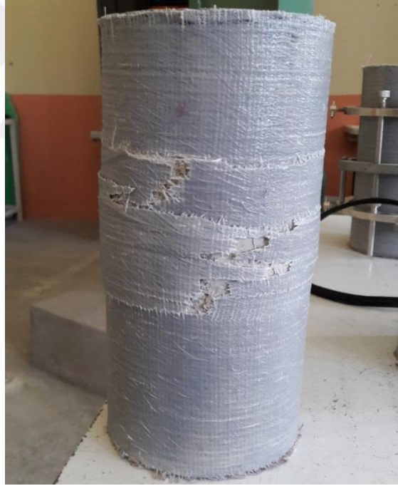
Şekil 5.41. GFRP-C20 Tek Sarım Beton Numunesi Deney Sonrası
