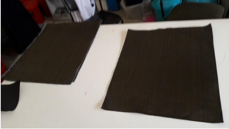
Şekil 5.12. 300x600 mm Ölçülerinde Kesilerek Hazırlanan Kumaşlar
