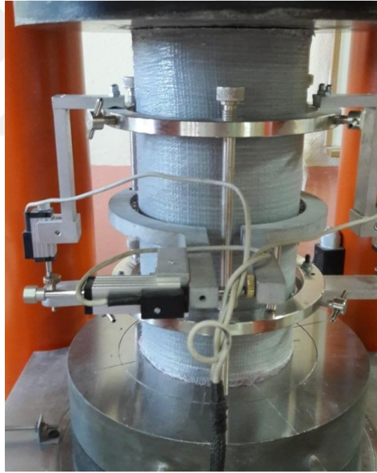
Şekil 5.49. GFRP-C75 Tek Sarım Beton Numunesi Deney Sonrası
