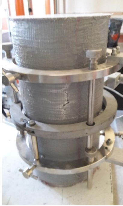
Şekil 5.51. GFRP-C75 Çift Sarım Beton Numunesi Deney Sonrası
