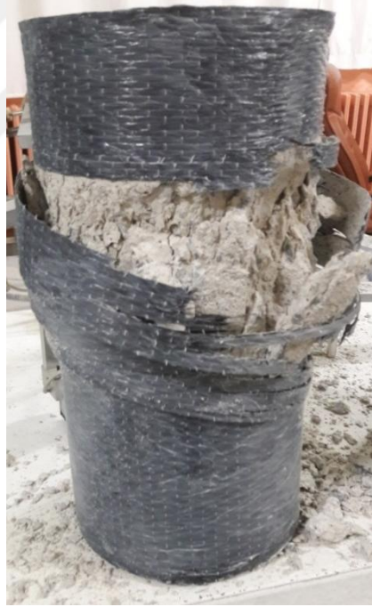
Şekil 5.26. CFRP-C20 Tek Sarım Beton Numunesi Deney Sonrası
