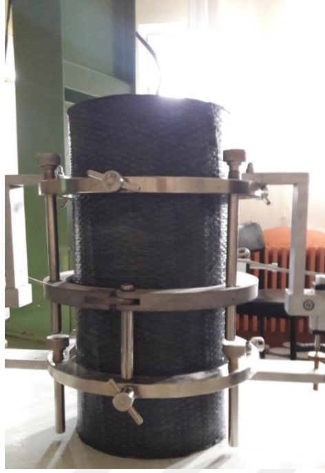
Şekil 5.33. CFRP-C75 Tek Sarım Beton Numunesi Deney Öncesi
