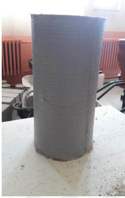
Şekil 5.50. GFRP-C75 Çift Sarım Beton Numunesi Deney Öncesi
