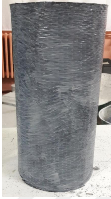
Şekil 5.25. CFRP-C20 Tek Sarım Beton Numunesi Deney Öncesi
