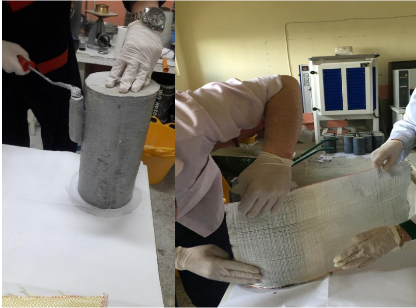
Şekil 5.16. Cam Elyaf Kumaşların Betona Sarılması
