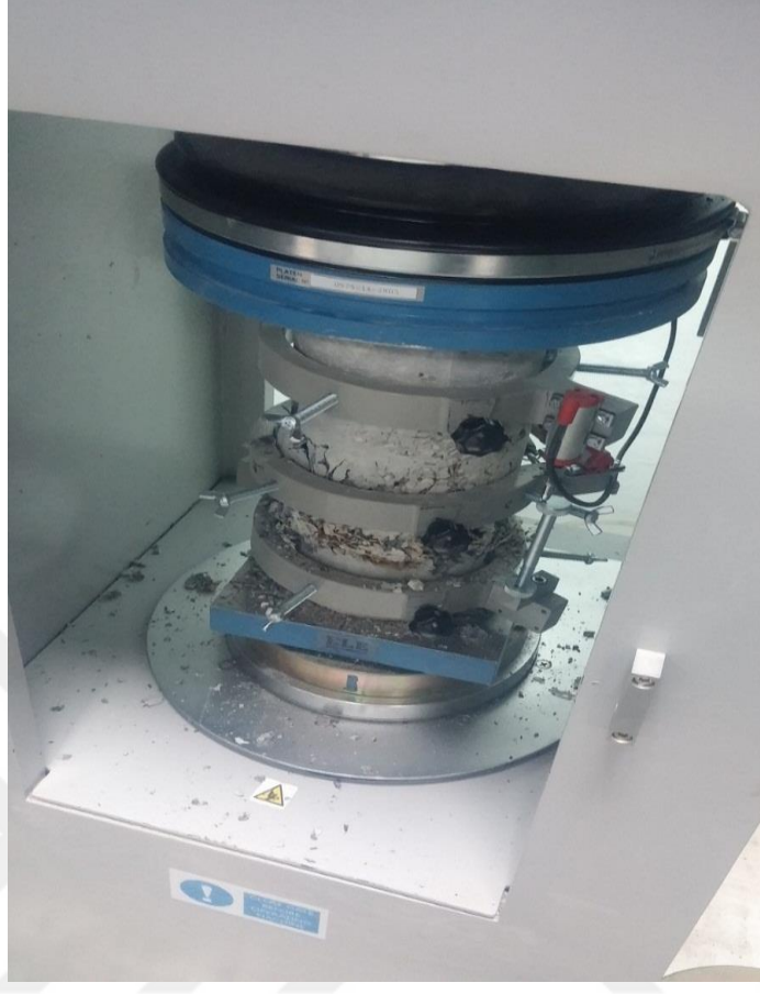
Şekil 3.18. Şekil Değiştirme Ölçerlerin (LVDT) Okuma Değerleri Alması
