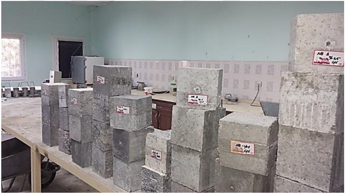
Şekil 3.8. Deney İçin Hazırlanmış Küp ve Silindir Numuneler
