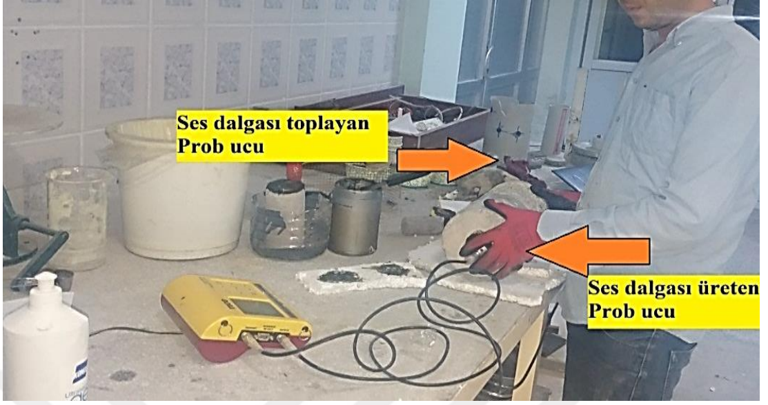
Şekil 3.14. Ultrases Geçiş Hızları Deneyi
