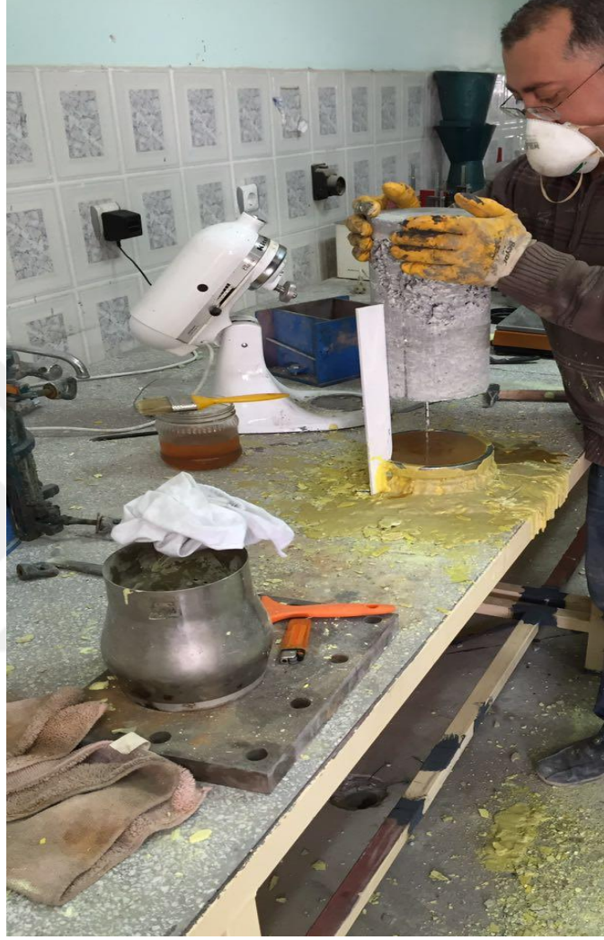
Şekil 3.16. Numunenin Başlıklama Kalıbına Oturtulması
