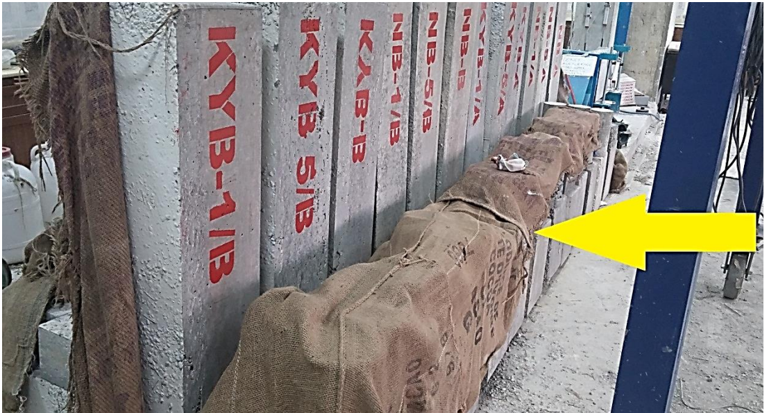
Şekil 3.11. Numunelerin Telis Bezi ile Muhafaza Edilmesi
