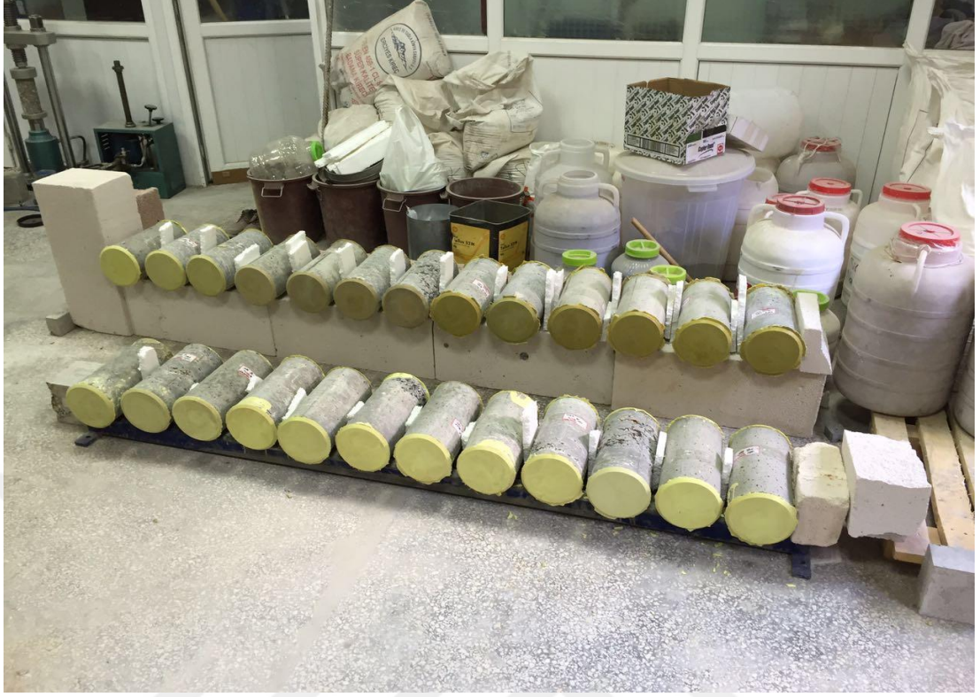
Şekil 3.17. Başlıklanma İşlemi Tamamlanmış Numuneler
