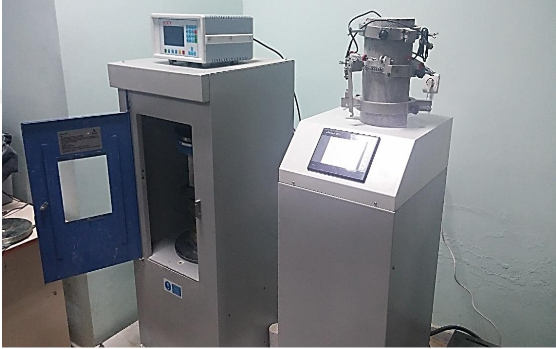
Şekil 3.20. Statik Elastisite Modülünün Bulunmasında Kullanılan Basınç Presi ve Deney Düzeneği
