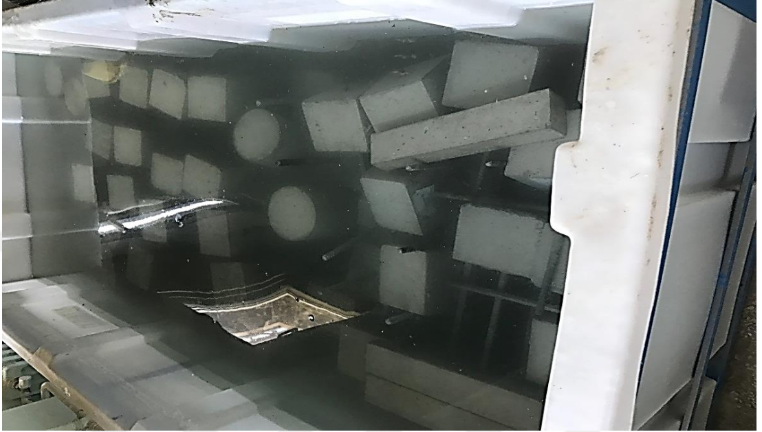
Şekil 3.10. Deney Numunelerinin Kür Havuzunda Bekletilmesi
