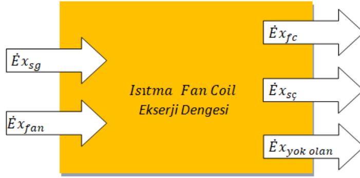
Şekil 4.9. Isıtma Fan Coil İçin Ekserji Dengesinin Şematik Gösterimi
