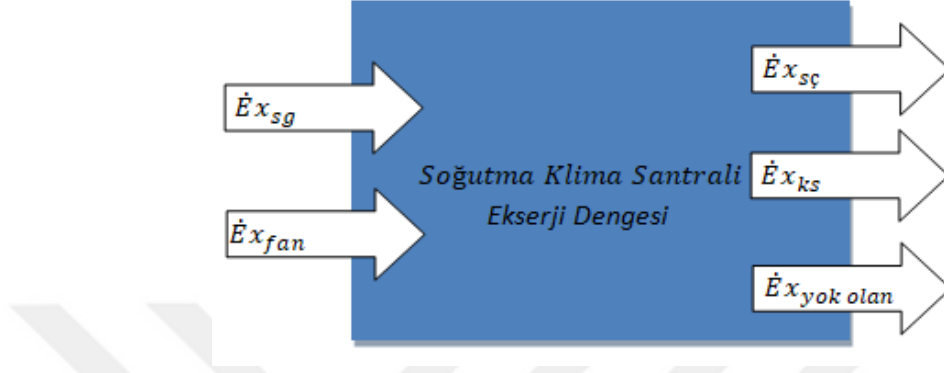
Şekil 4.12. Soğutma Klima Santrali İçin Ekserji Dengesinin Şematik Gösterimi
