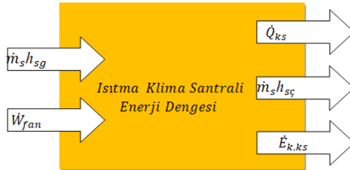
Şekil 4.11. Isıtma Klima Santrali İçin Ekserji Dengesinin Şematik Gösterimi
