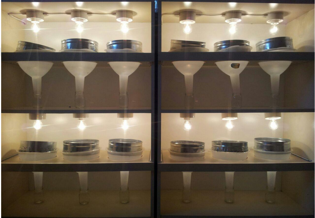
Şekil 2.2. Birleştirilmiş Berlese hunilerinden oluşan toprak akarlarını ayıklama düzeneği
