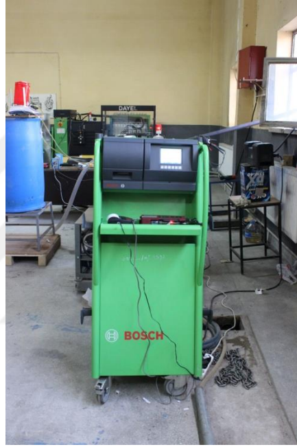
Şekil 3.4. Egzoz Emisyon Ölçüm Cihazı
