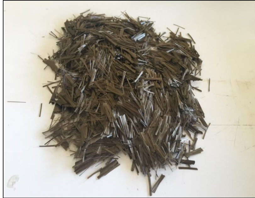
Şekil 3.3. Çalışmada Kullanılan Bazalt Lif
