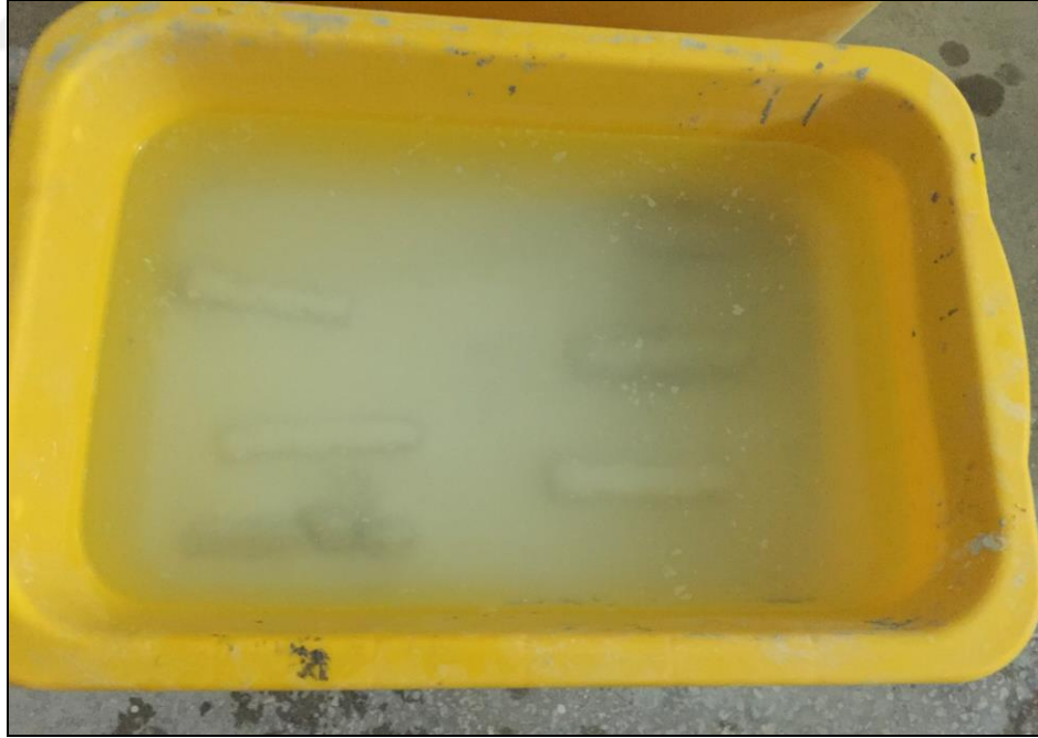
Şekil 4.9. Numunelerin 900 °C Sıcaklığa Maruz Bırakıldıktan Sonraki Ani Soğuma Durumu
