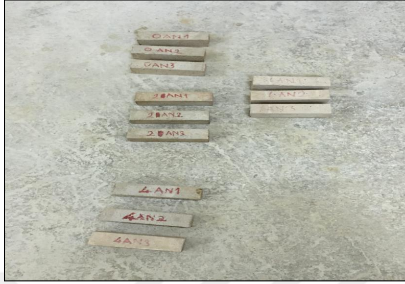
Şekil 4.4. Numunelerin 300 °C Sıcaklığa Maruz Bırakıldıktan Sonraki Normal Soğuma Durumu
