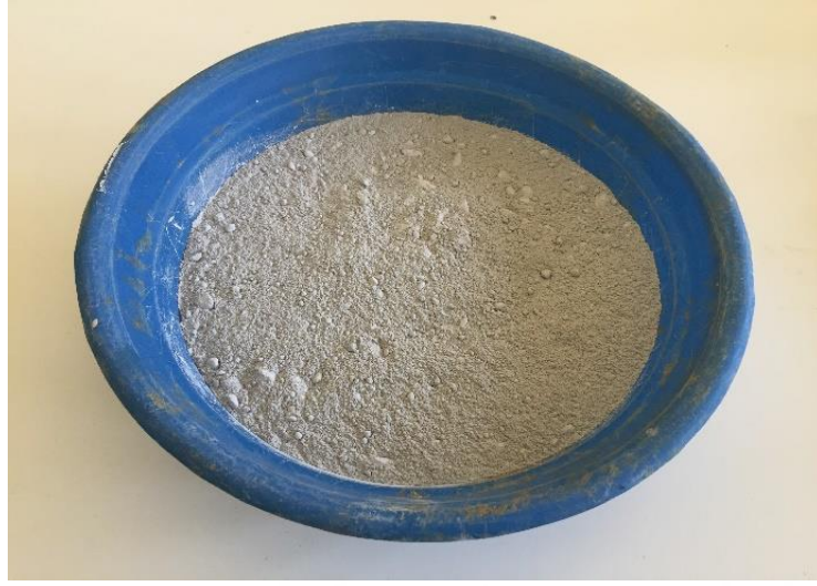
Şekil 3.1. Çalışmada Kullanılan Silis Dumanı
