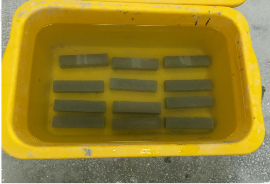
Şekil 4.7. Numunelerin 600 °C Sıcaklığa Maruz Bırakıldıktan Sonraki Ani Soğuma Durumu
