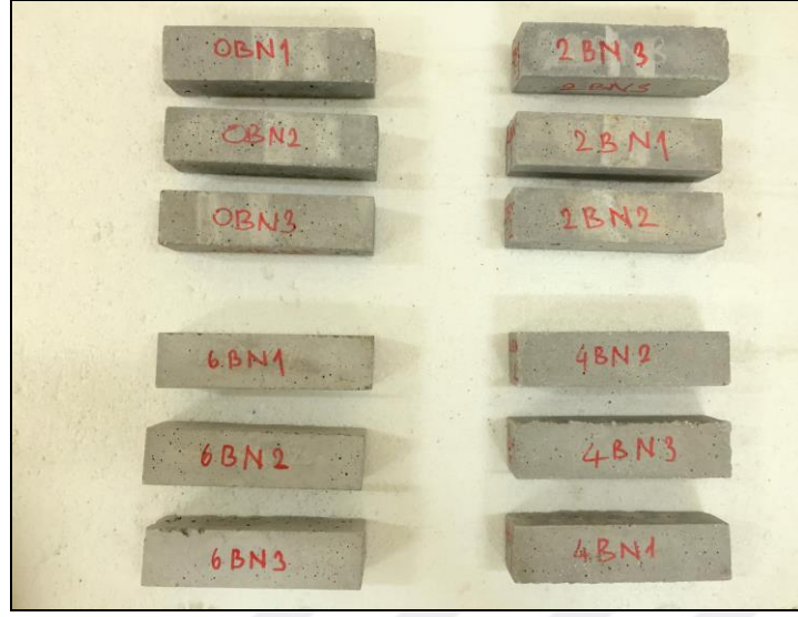
Şekil 4.6. Numunelerin 600 °C Sıcaklığa Maruz Bırakıldıktan Sonraki Normal Soğuma Durumu
