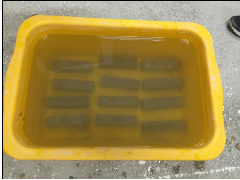
Şekil 4.5. Numunelerin 300 °C Sıcaklığa Maruz Bırakıldıktan Sonraki Ani Soğuma Durumu
