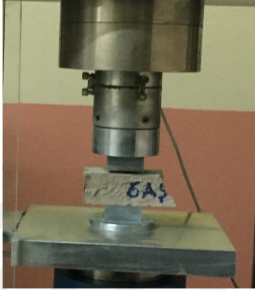
Şekil 3.8. Basınç Dayanımı Deney Düzeneği
