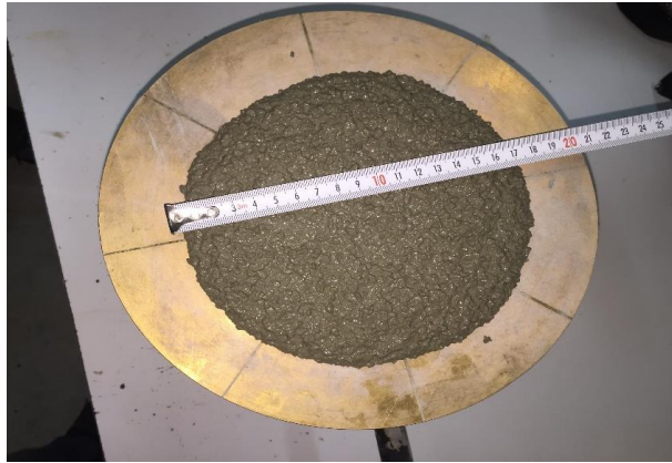
Şekil 3.6. Yayılma Tablası Deney Aleti
