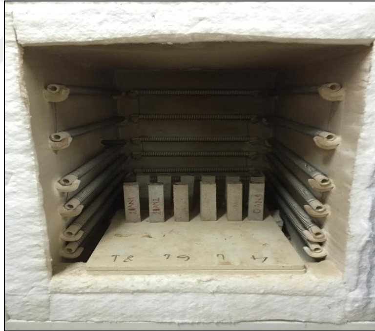
Şekil 4.1. Numunelerin 300 °C Sıcaklığa Maruz Bırakıldıktan Sonraki Durumu
