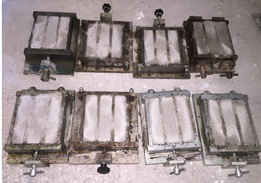
Şekil 3.4. 24 Saat Kalıpta Bekletilen Numuneler
