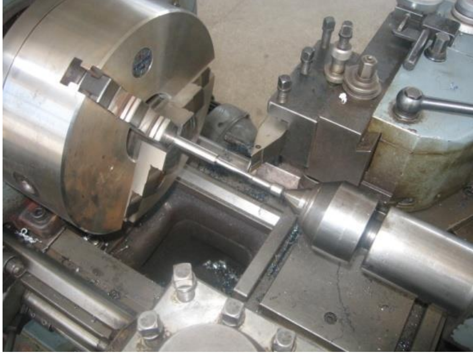
Şekil 3.16. Kopya Torna Tezgâhı Ayna-Punta Arası Numune Üretimi
