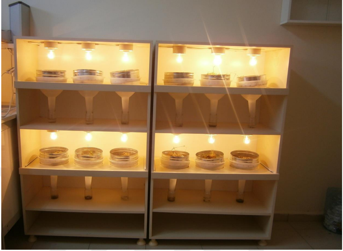
Şekil 2.2. Birleştirilmiş Berlese hunilerinden oluşan toprak akarlarını ayıklama Düzeneği
