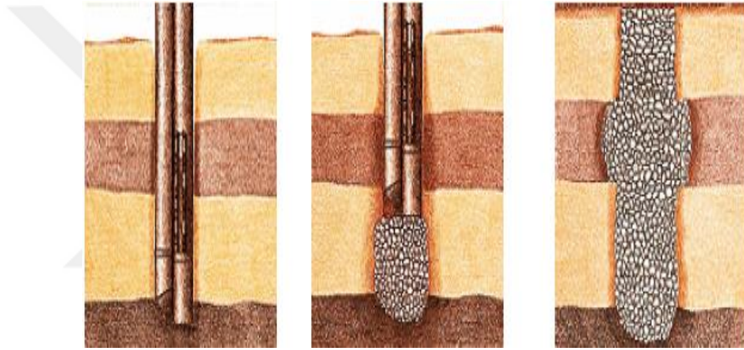
Şekil 3.8. Vibro-Öteleme Metodu (Kuru Metot) ile taş kolonların imalatı [145].
