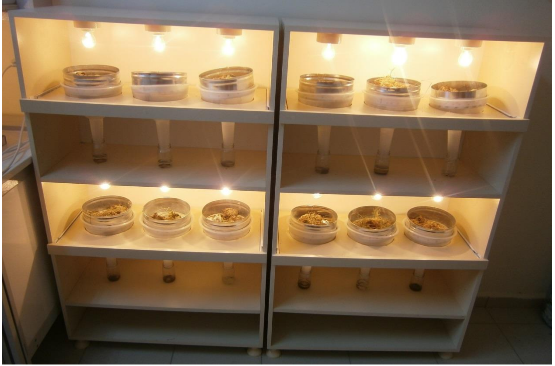
Şekil 2.2. Birleştirilmiş Berlese Hunilerinden Oluşan Toprak Akarlarını Ayıklama Düzeneği
