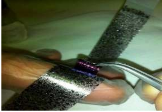
Şekil 3.6. Si tabaka üzerine grafenin aktarılması
