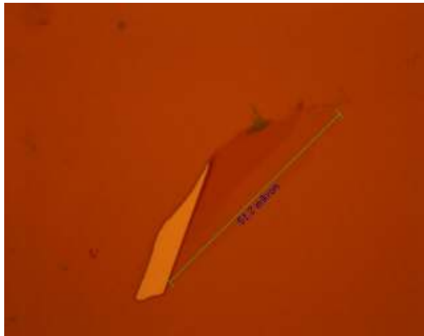
Şekil 3.8. Grafen ve Grafit Tabakalarının 100X Merceкли Optik Mikroskopta Görünümü ve Grafenin Boyutu
