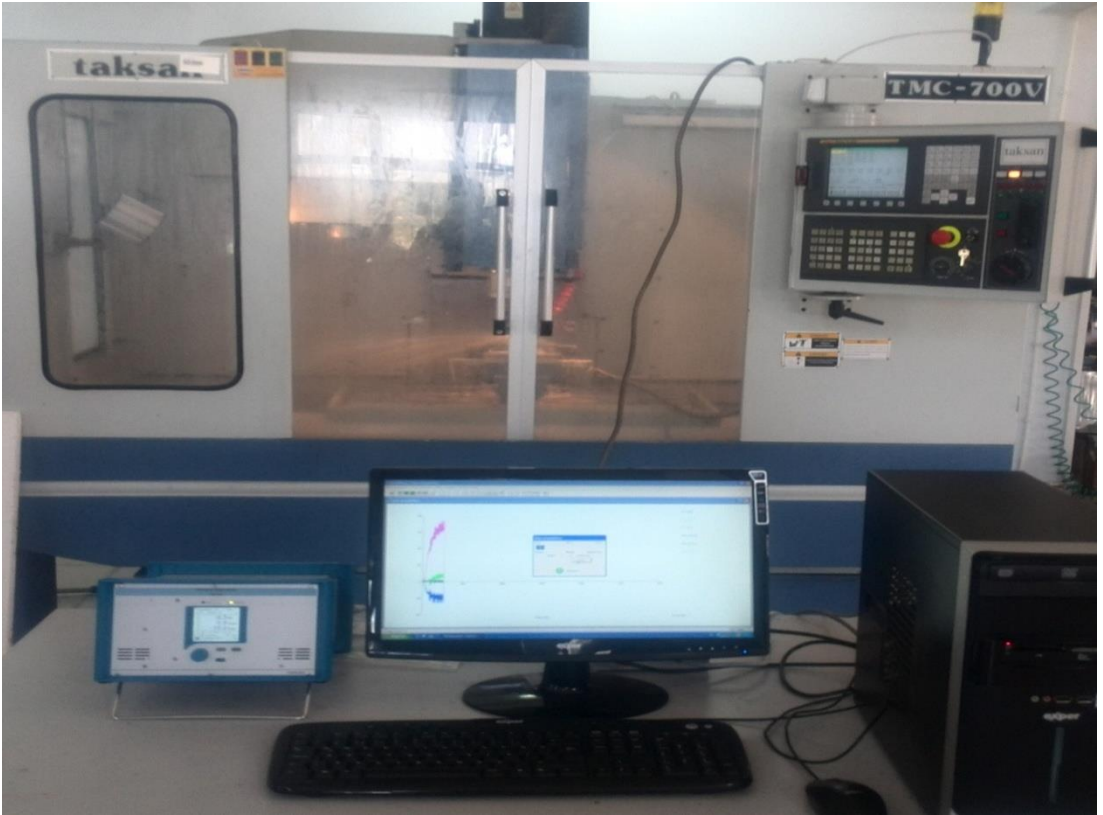
Şekil 3.19. Dinamometre ile Kuvvet Analizi
