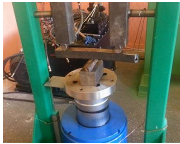
a) Deney düzeneği (Basit mesnetli kiriş ile yüklü) b) 3/2 kartuş valfli sistem ( \lambda=150, \delta=9.8; A_r=1 ; max. 40 ton) c) Servovalfli sistem ( \lambda=5, \delta=2; A_r=1 ; max. 40 ton)
