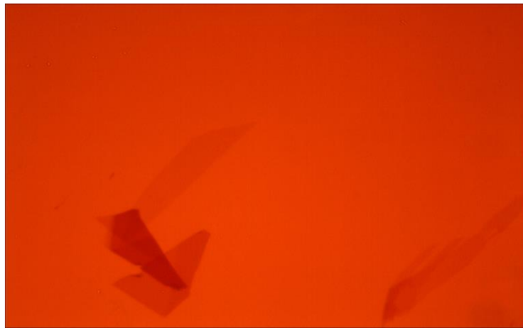
Şekil 3.2. Si/ \text{SiO}_2 alttaş üzerindeki grafenin optik mikroskop (100x) görüntüsü.
