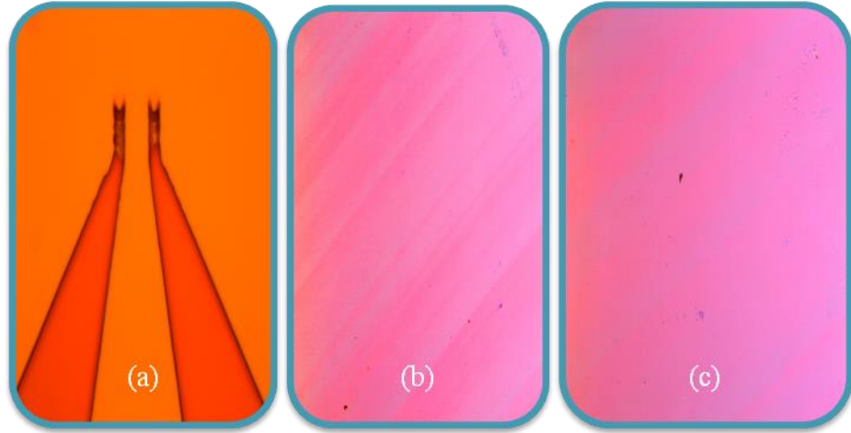
Şekil 4.20. Si/SiO 2 'nin 30 dk M,N-dimethylformamide sıvısında bekletildikten sonraki görüntüsü; (b) 5x ve (c) 10x.
