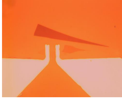
Şekil 4.26. Cr/Au (20/30nm) grafen alan etkili transistör.
