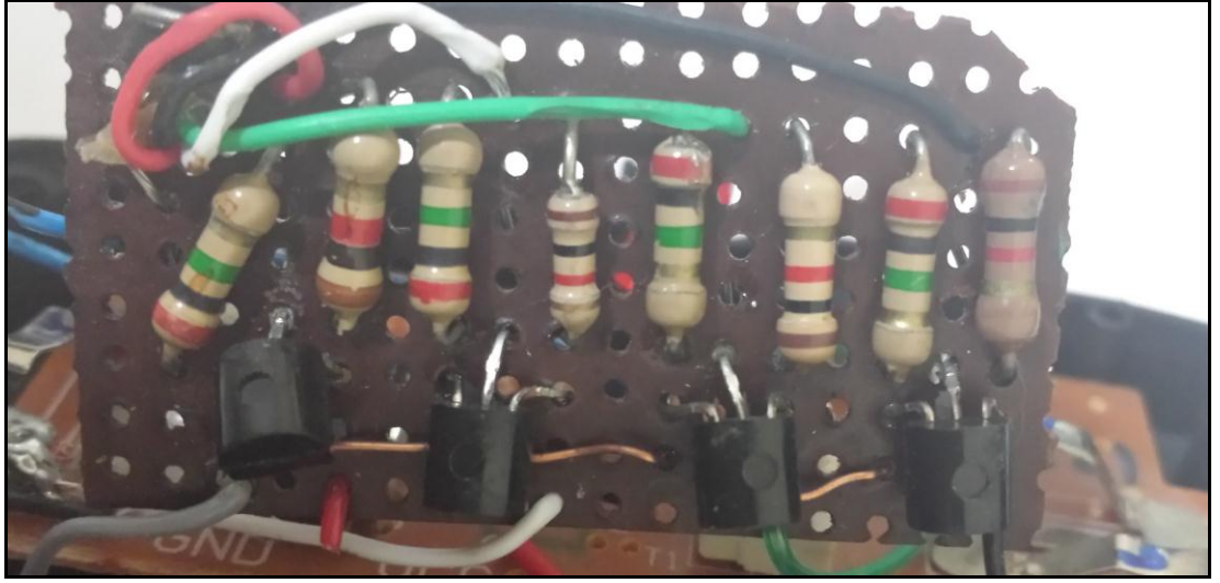
Şekil 4.2. Model araba alıcısı ile bilgisayar bağlantı devresi
