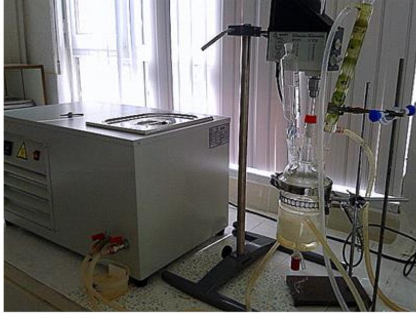
Şekil 4.6. Emülsiyon polimerizasyon düzeneği
