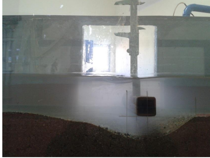
Şekil 5.5. Boru hattı altında meydana gelen oyulma derinliğinin ölçülmesi
