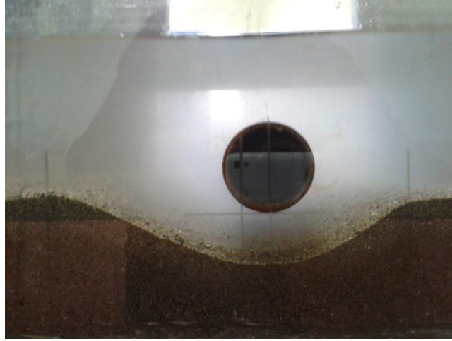
Şekil 5.10. Dairesel kesitli boru altında oyulma
