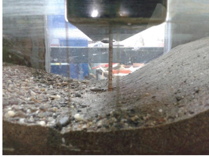
Şekil 5.6. Boru hattı altında meydana gelen oyulma derinliğinin ölçülmesi
