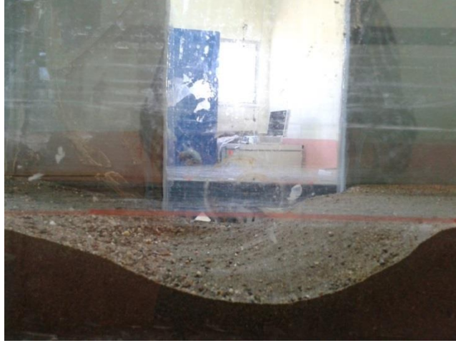
Şekil 5.11. Düşü havuzunda bulunan taban malzemesinin suyunun boşaltılması
