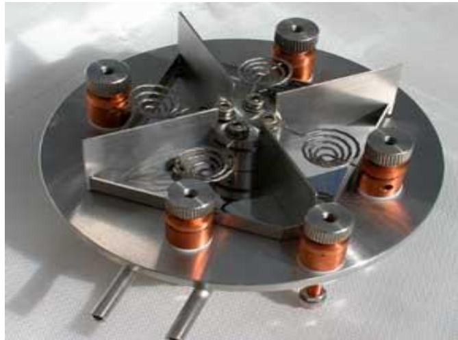
Şekil 3.4. Termal Buharlaştırma Sisteminde Isıtıcı Flamanların Fotoğrafi
