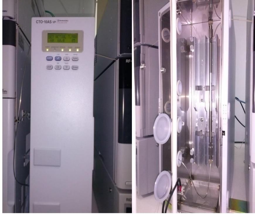
Şekil 3.6. HPLC kolon fırını ve HPLC kolonu
