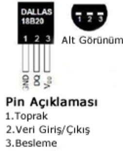
Şekil 3.2. DS1820 Sıcaklık Sensörünün PIN Diyagramı.
