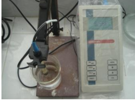
Şekil 5.2. Consort C931 marka dijital pH metre
