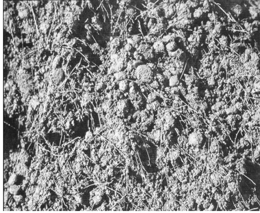
Şekil 2.4 Çelik tellerin taze beton içerisindeki dağılımı.
