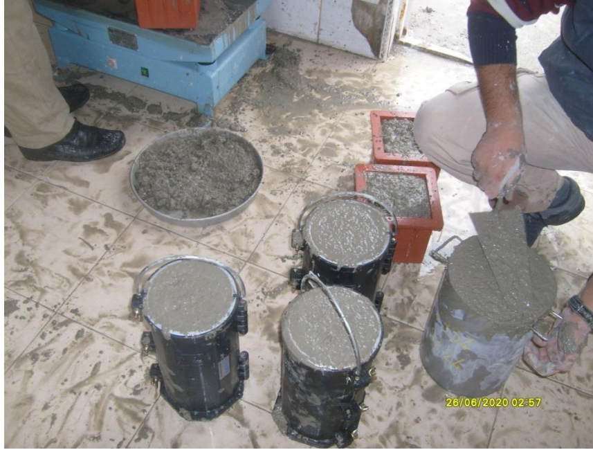
Şekil 3.4 Beton numulerin üretimi–3
