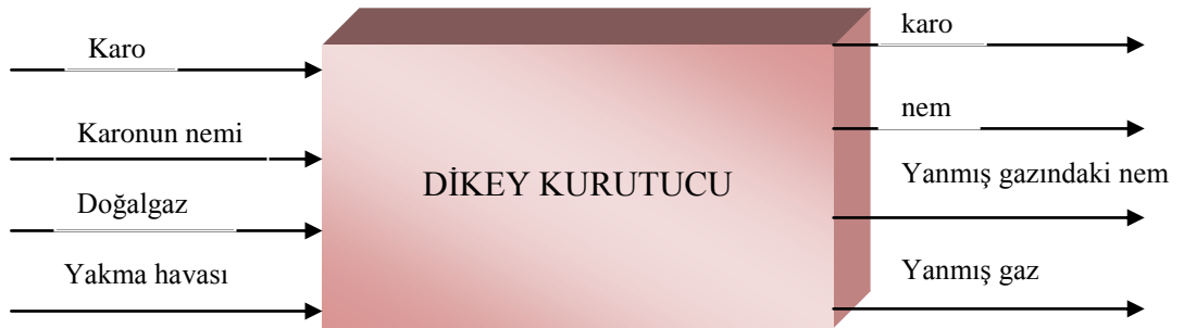
Şekil 4.2. Dikey Kurutucuya Giren ve Çıkan Materyallerin Gösterimi.
