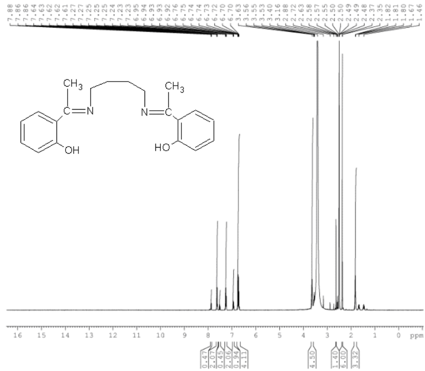
Şekil 4.8. N,N'-bis(2-hidroksi-asetofeniliden)-1,4-diaminobütan Schiff bazının (LHABU) H-1 NMR spektrumu
